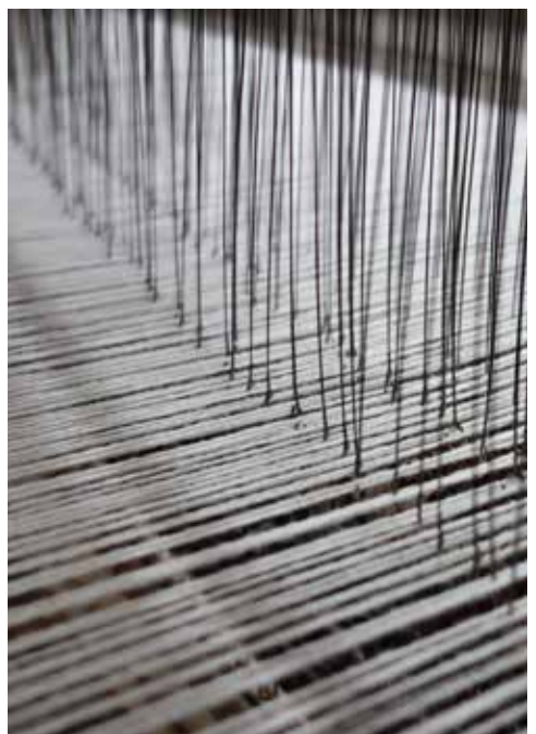
Kette schären an der Schärmaschine, Kette anknuten, Litzen mit Kettbespannung
