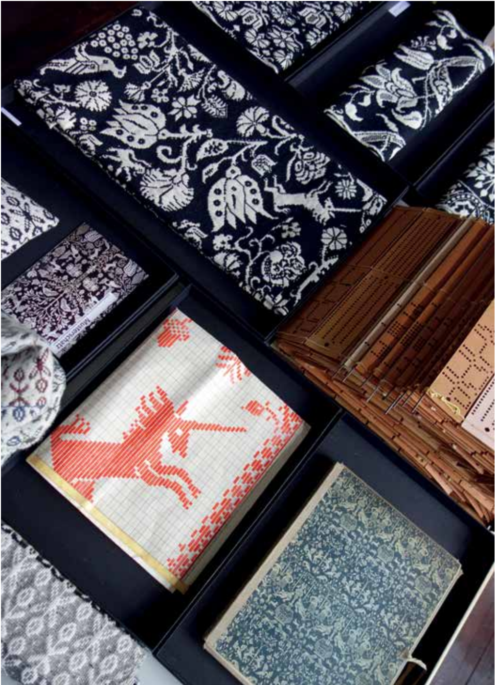
Beiderwandgewebe, Jacquardkartenlauf, Musterzeichnung mit Einhorn-Motiv
