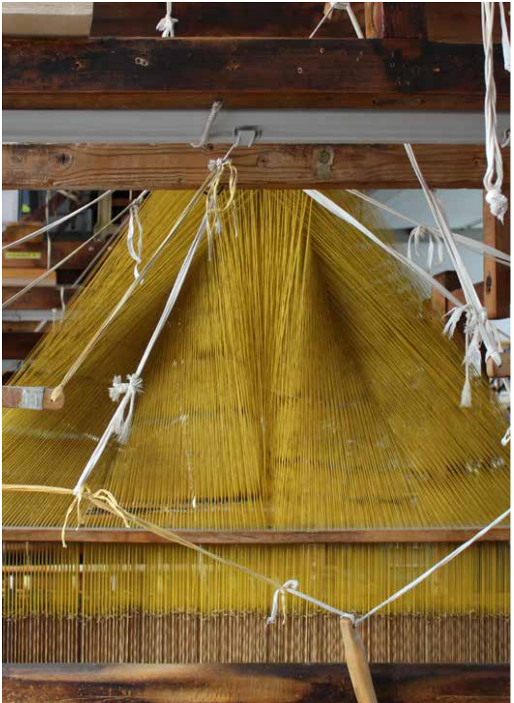
Harnischverschnürung zur Fadensteuerung am Jacquardwebstuhl
