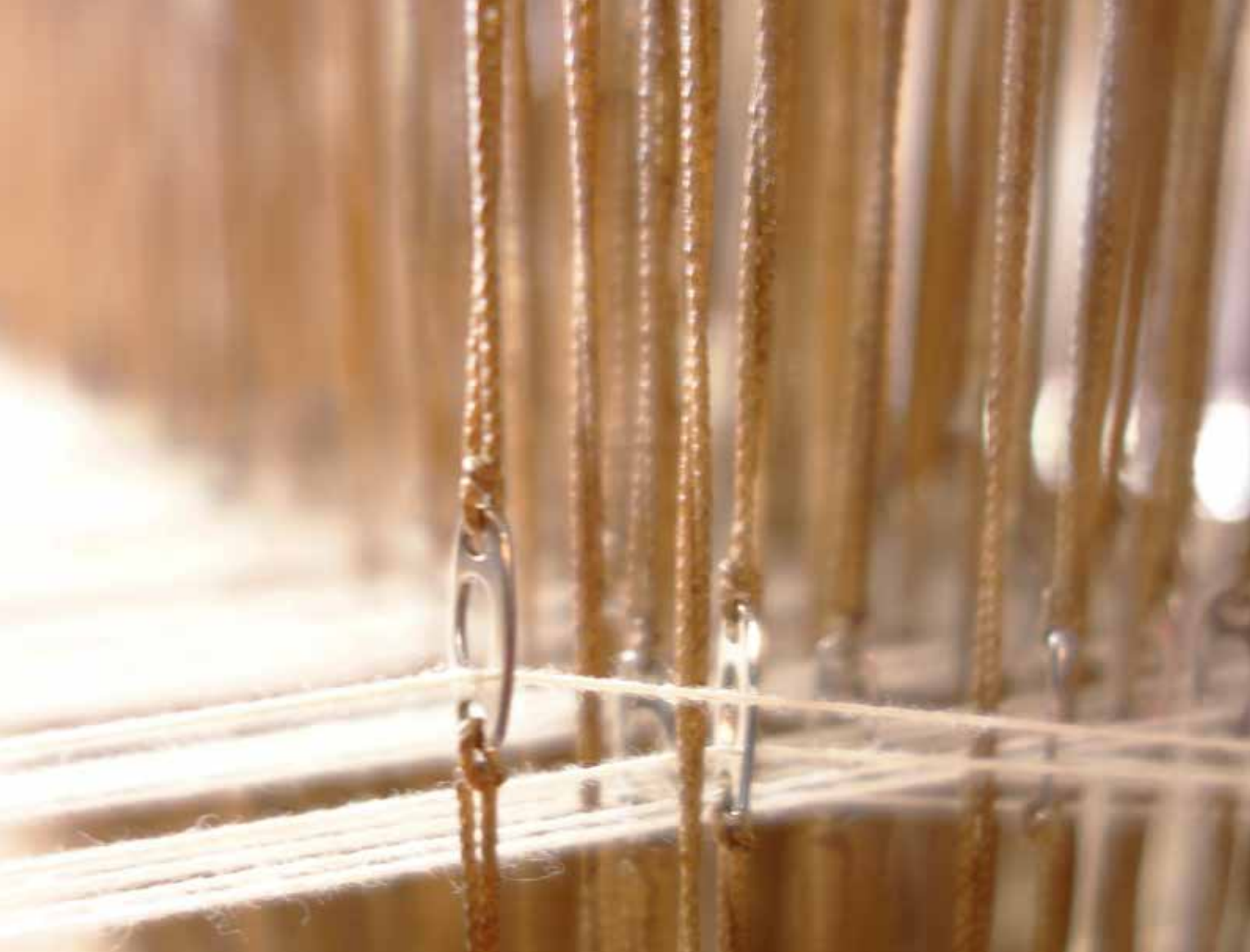
Gehobene Kettfäden am Lochkartenjacquard. Foto: Lucia Schwalenberg.
